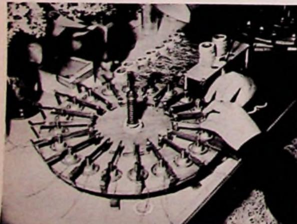
Links: Auf dieser Klebvorrichtung werden die Distanzringe und Anschlußlitzen auf den Ringpolschuh des Mikrofonsystems festgeklebt und bis zum Trocknen zusammengepreßt
