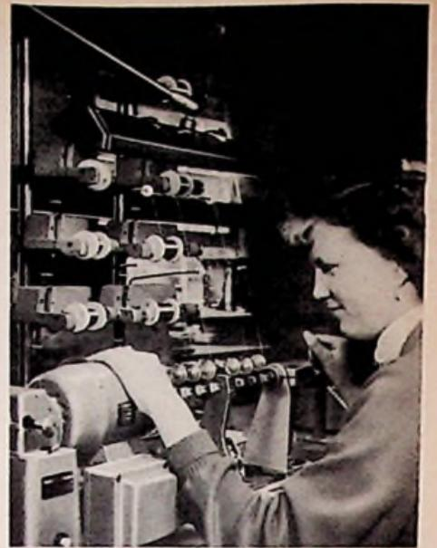
Sechs Miniaturübertrager entstehen gleichzeitig an dieser Feindraht-Wickelmachine
